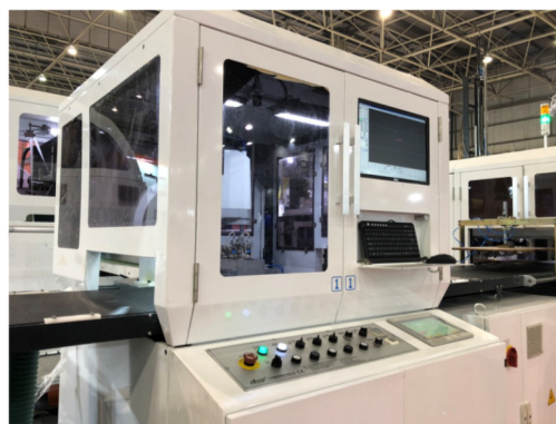
SCARA (Selective Compliance YAMAHA Robot Arm) para localizar a caixa de cartão cinzento Câmera de origem Alemã BALSER, com sistema de rastreamento Japan VS Lens Precisão: \pm 0,05 mm. Tempo de mudança de tamanho: 10 min.
